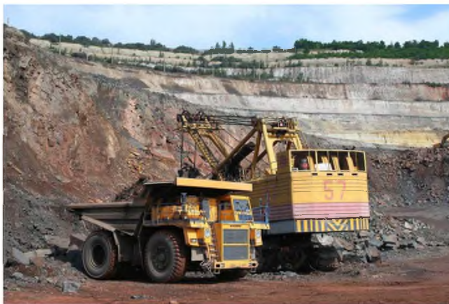
Рис. 4.8. Погрузка горной массы в автомобили БелАЗ (СГОК)
